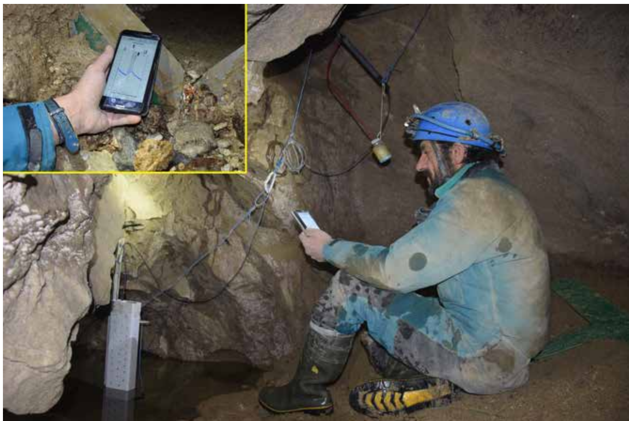
Fig. 18 – Prelievo dati di livello mediante tecnologia Bluetooth, ciò permette di non spostare la sonda di misura del livello dell'acqua riducendo così il rischio di errore (foto E. Sfrisi).
