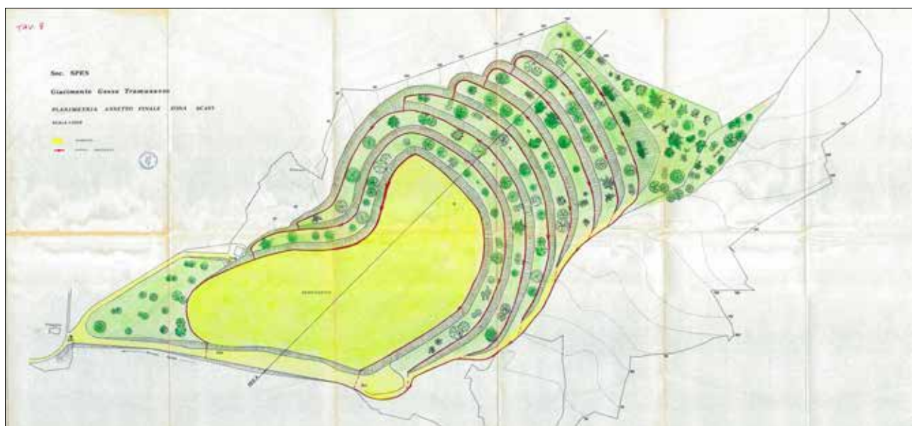
Fig. 11 – Relazione di Franco De Luca (1984): l'assetto finale del sito della cava SPES dopo la conclusione dei progettati lavori di bonifica e risanamento, attuati tramite escavazione a cielo aperto (elaborati inediti conservati in BIBLIOTECA COMUNALE DI BORGO TOSSIGNANO, b. SPES).
