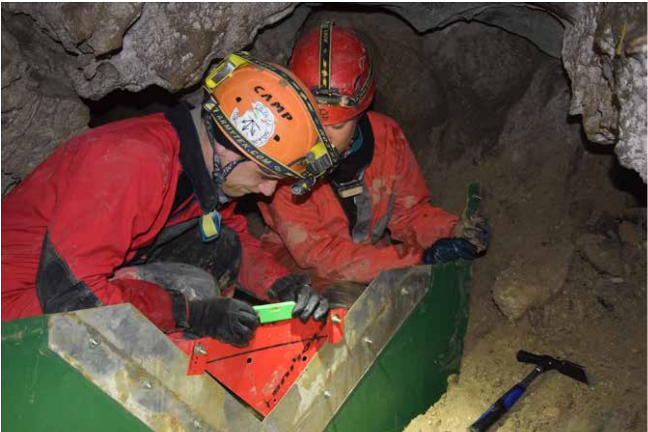
Fig. 15 – Messa in posa dello stramazzo presso l'apporto a sifone in sinistra idrografica (foto S. Zauli).
