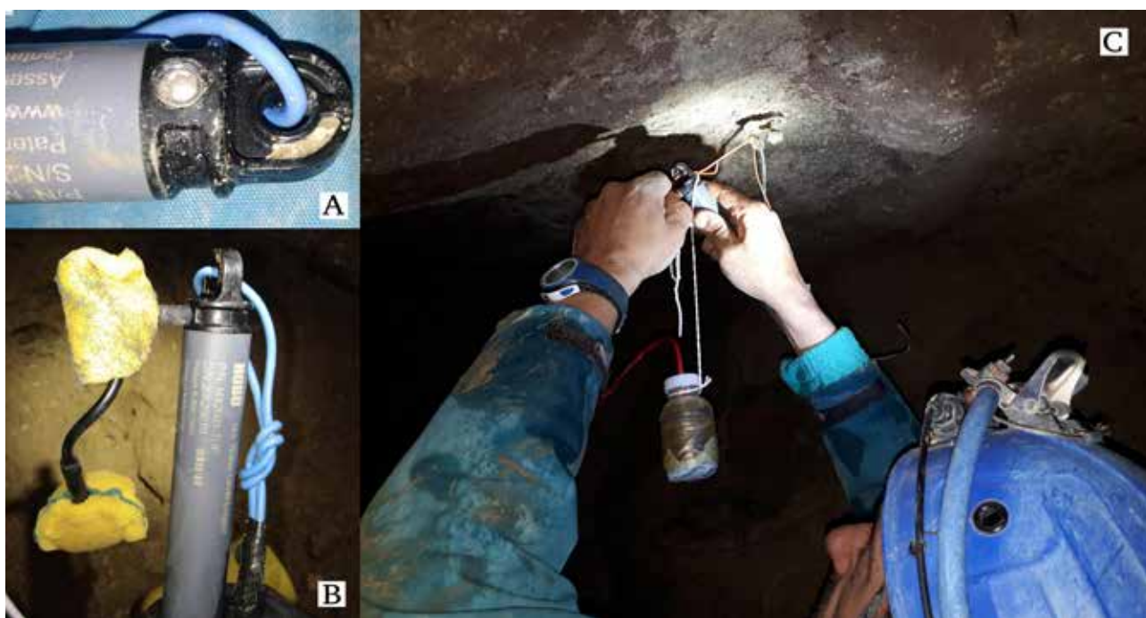
Fig. 19 – Soluzione trovata per ripristinare il regolare funzionamento del sensore per la misura della pressione barometrica, sul cui filtro si era depositato uno strato di condensa che lo ha isolato impedendogli di recepire le variazioni di pressione. Il malfunzionamento ha interessato il periodo febbraio-maggio 2020 (fig. 21).
