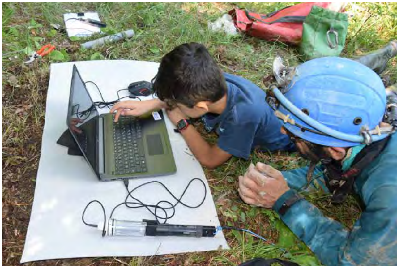
Fig. 17 – Scarico dati conducibilità da datalogger tramite interfaccia ottica collegata a PC portatile sul quale è stato installato software della Hobo (foto E. Sfrisi).
